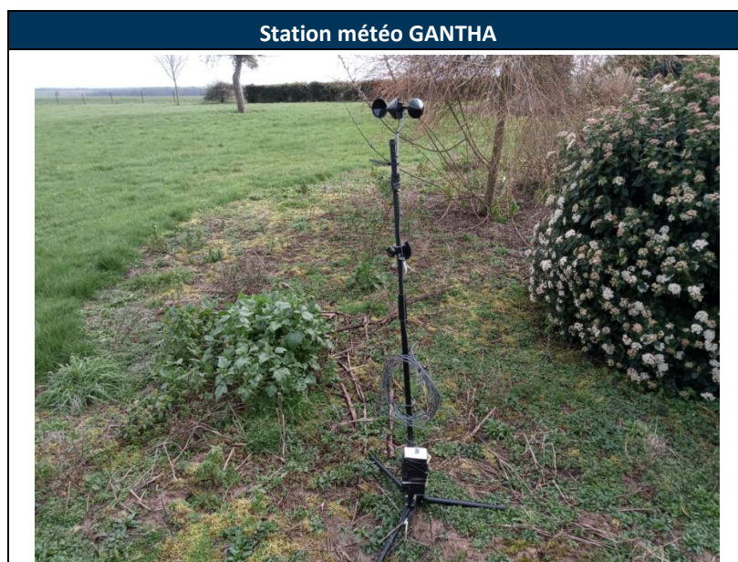
Figure 2 : Station météorologique à 1,5 m
